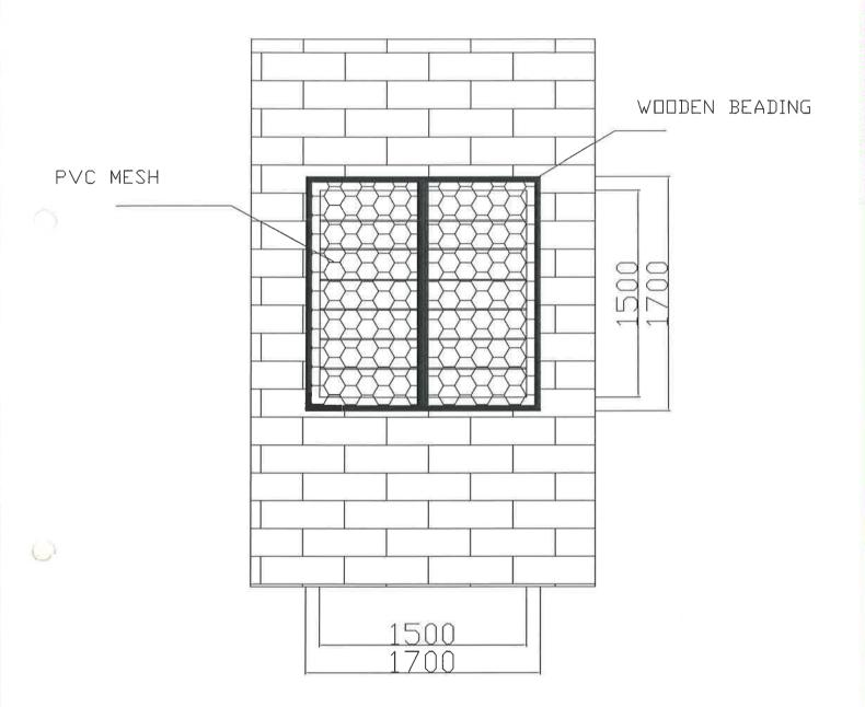
TYPICAL WINDOW SIZE 1500 X 1500 TYPICAL FRAME REQUIRED 850  $\times$  1700 (2Nos)
